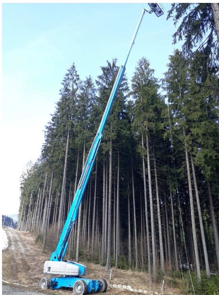
Vysokozdvížné plošina s vysílacím systémem v koši jako simulovaná základnová stanice
